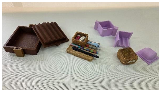
IMAGEN 3. Organizador de escritorio: piezas moldeadas con pulpa de cartón y aserrín, y moldes impresos en PLA. Proyecto de Gallardo, Riera y Dos Santos.
